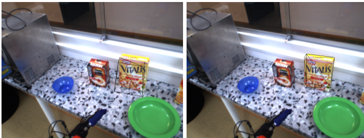
Abbildung 4: Ergebnis der Lagebestimmung für eine Beispiel-Szene. Links: unter Verwendung des monokularen Ansatzes. Rechts: unter Verwendung des Stereo-basierten Ansatzes.
