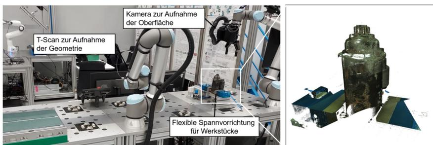
Abb. 2: Befundungsstation zur visuellen Inspektion von Anlassermotoren.
